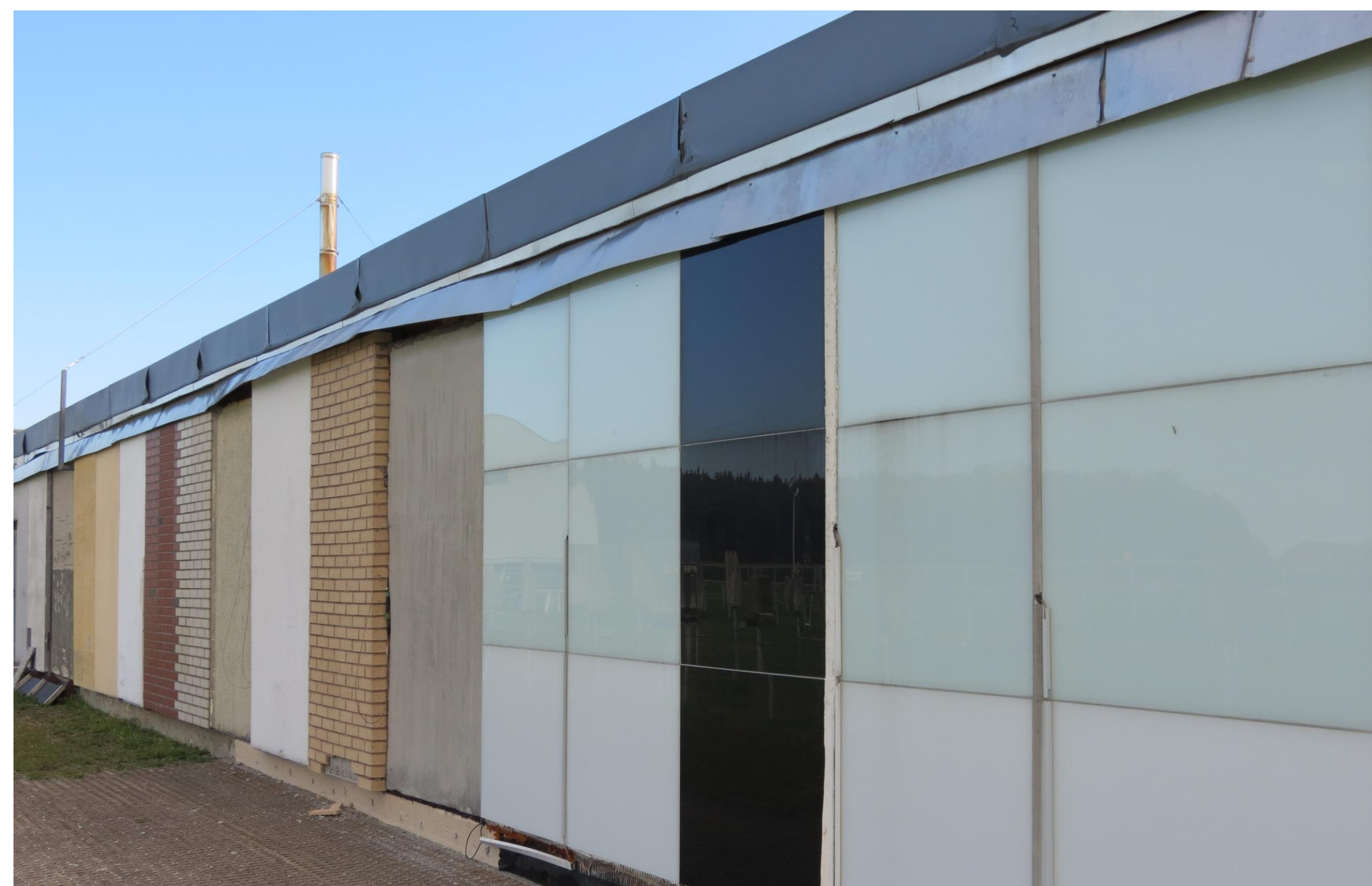
Hình 2: Không gian có tấm tường phơi lộ tại địa điểm thử nghiệm của Viện Vật lý Công trình Fraunhofer
